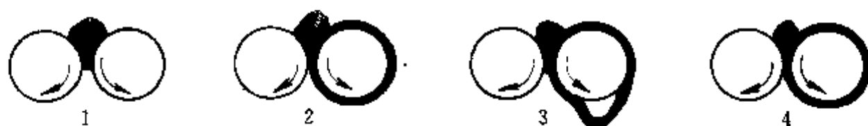
图 3-20 橡胶在开炼机中的几种状态
