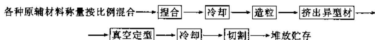
图 5-50 塑料窗用异型材的生产工艺流程
